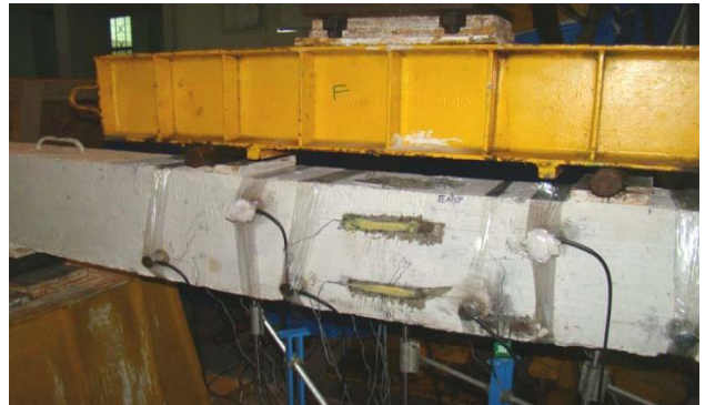
(d) final cracking at ultimate load
