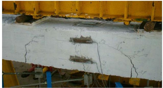
(d) final cracking at ultimate load
