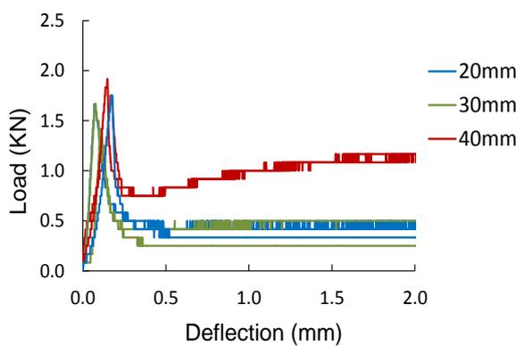
(d) Straight R-nylon fiber with 2.0% fiber fraction
