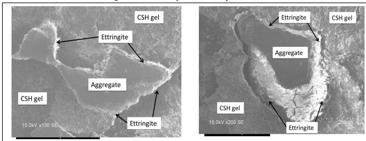
Fig. 16 – Polished specimen: Sample DS1
